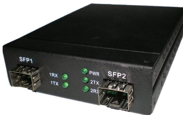
Конвертер предназначен для применения в сетях Fast Ethernet/STM-1/STM-4/Gigabit Ethernet и предназначен для конвертирования среды передачи данных посредством применения SFP модулей для различных медиа сред. Медиаконвертер является протоколонезависимым прибором, поддерживающий одинаковые протоколы и битрейт диапазона 100Mbps - 1.25Gbps на обоих SFP slot.
