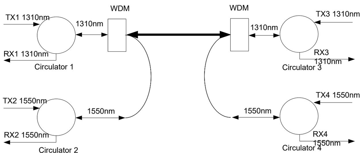
Модуль построен на циркуляторах, позволяющих передавать два двухволоконных дуплексных канала передачи данных по одному волокну. Модуль является энергонезависимым устройством и применим для 10G Ethernet приложений.
